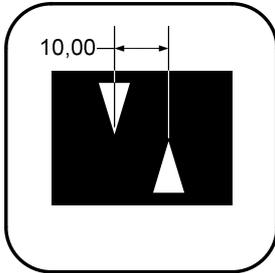
Das Gitter wird so verschoben, dass beim Blick durch das Gitter, das obere rechte Maximum 1. Ordnung genau über dem unteren linken Maximum 1. Ordnung steht. Aus dem Abstand des Gitters vom Doppelkeilspalt und den oben genannten Größen wird anschließend die Wellenlänge des Lichtes berechnet.
